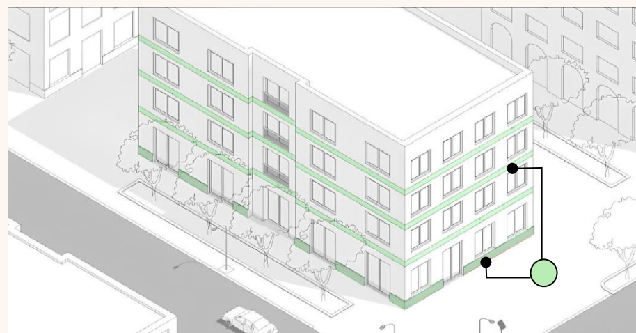
Цоколь в тон перекрытий
